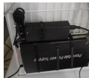
que 30 minutes. La solution pour augmenter l'autonomie de l'informatique sur les chariots infirmiers consiste à acquérir des extensions de batterie longue durée qui sont fixées sur les chariots en complément.
